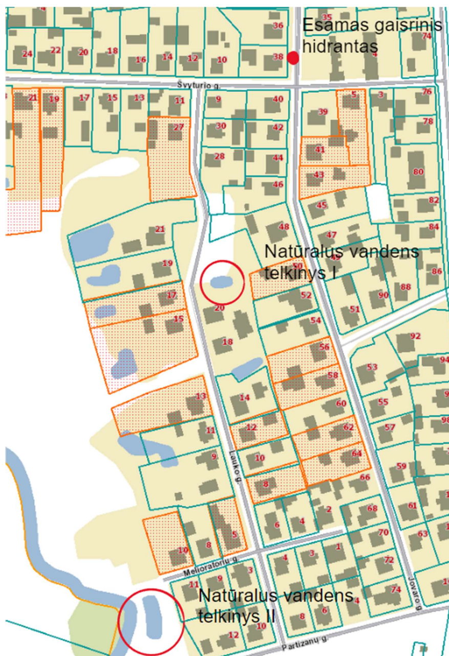
3 pav. Esamas gaisrinis hidrantas ir natūralūs vandens telkiniai
